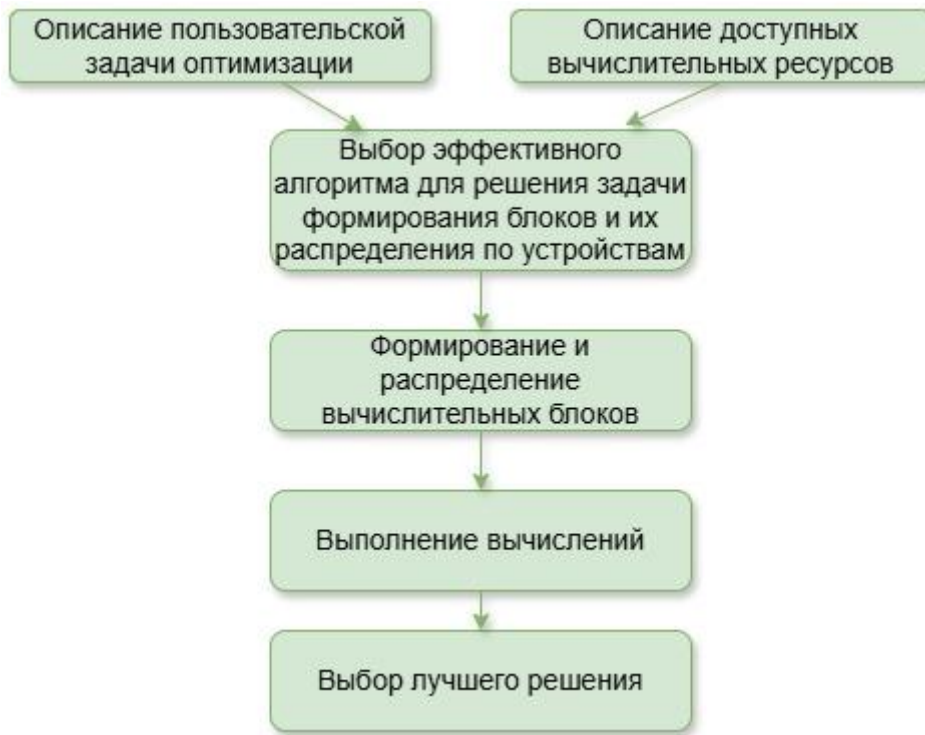
Рис. 1. Этапы метода распределенного решения вычислительно сложных задач оптимизации с использованием гетерогенного коллектива вычислительных устройств
