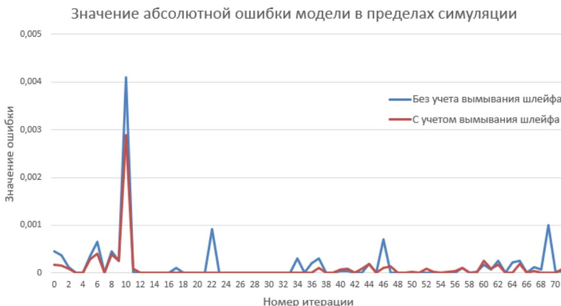
Рис. 3. Абсолютная ошибка моделей с учетом и без учета размывания в пределах одной симуляции
