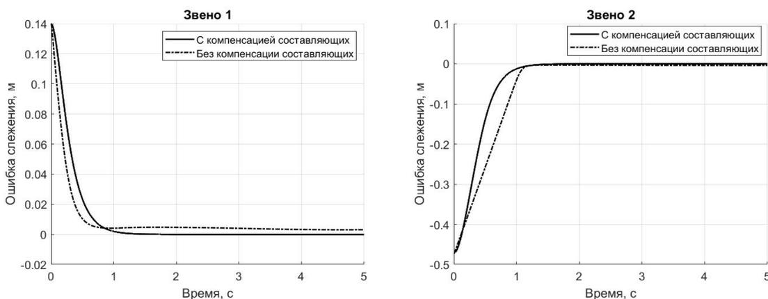
Рис. 2. Графики ошибок слежения  $e_{li}(t) = y_{li}(t) - g_i(t)$  (слева для  $i = 1$ , справа для  $i = 2$ )
