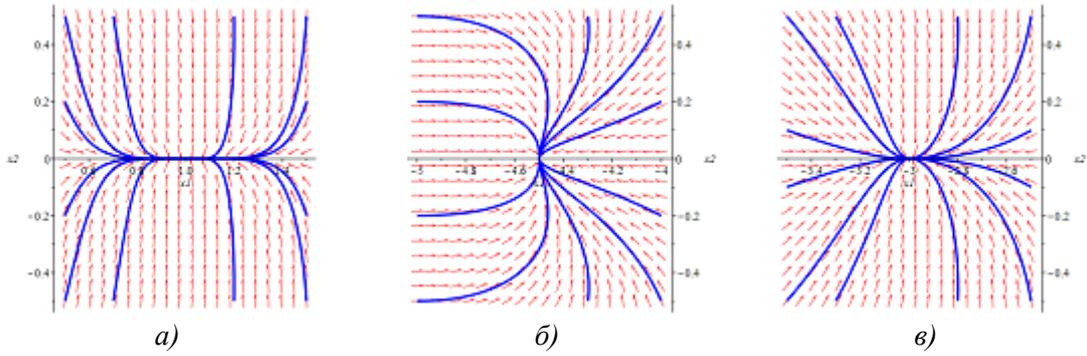
Рис. 1. Фазовые портреты на плоскости медленных переменных  $v_1, v_2$  для  $\varepsilon=0.1, v=5$  и характерных значений управляющего параметра:  $u=1$  (а),  $u=-4.5$  (б),  $u=-3$  (в)
