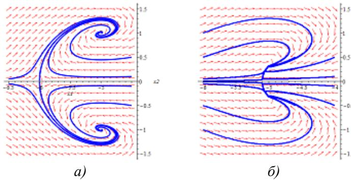
Рис. 2. Фазовые портреты на плоскости медленных переменных  $v_1, v_2$  для  $\varepsilon=0.1, v=5$  и характерных значений управляющего параметра:  $u=-6$  (а),  $u=-5.1$  (б)
