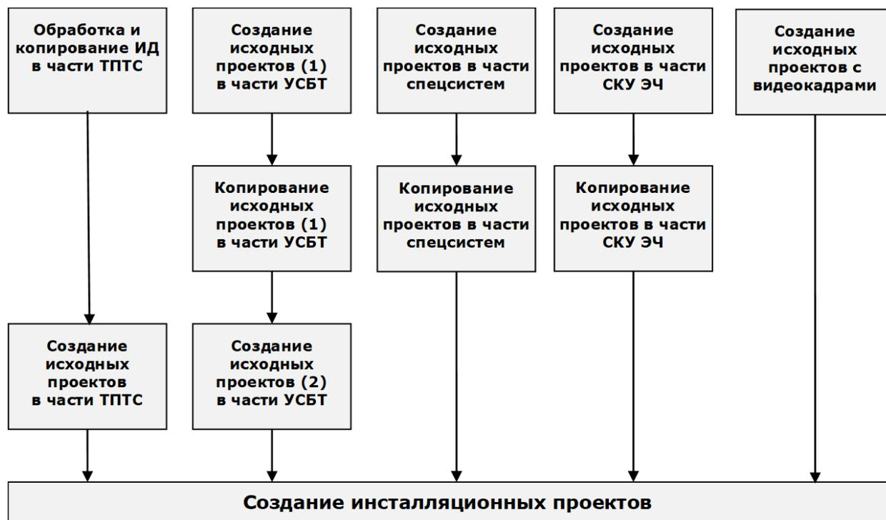
Рис. 1. Обобщенная схема внесения изменений в РБД СВБУ
