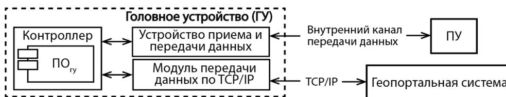
Рис. 4. Головное устройство геопортальной платформы
